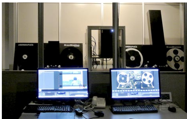
スキャンルーム＝モニター奥のクリーンルーム内に並ぶのが ScanStation (左が ScanStation Personal)
